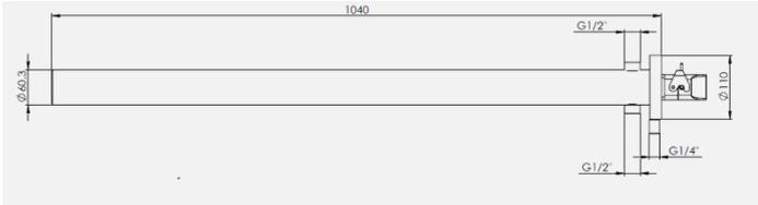
尺寸图 (PYROINC 320F、640F endoscope)
