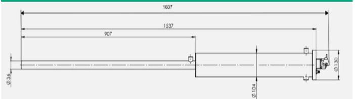
尺寸图 (PYROINC 1920/1600N endoscope)
