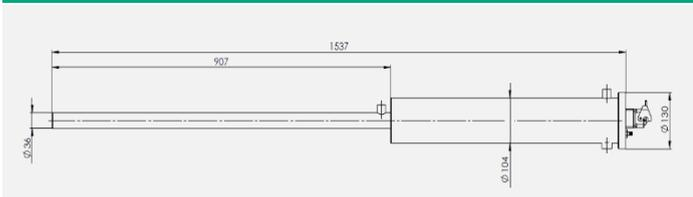
尺寸图 (PYROINC 768N endoscope)
